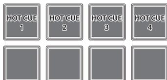
3. Drücken eines der leuchtenden Pads (für diese sind Hot Cue-Positionen gespeichert). Das Playback wird ab der ausgewählten Position gestartet.
