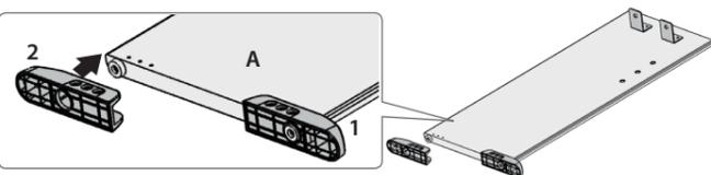
Die Schraubenlöcher der Stützen müssen sich auf der gleichen Seite befinden wie die Metallhalterungen.
